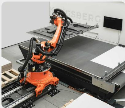
La configuración básica del Robotic Material Handler cuenta con un robot de pedestal de montaje rígido, capaz de manejar dos puntos de carga y descarga. Gracias a la configuración de dos mesas, la productividad puede aumentar hasta cuatro veces.
